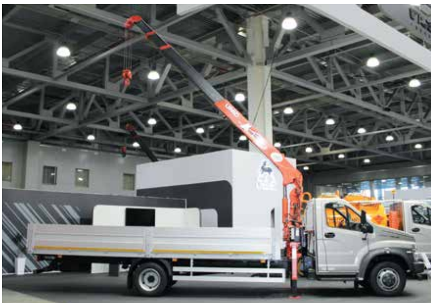
Кран-манипулятор Unic URC 374K, смонтированный на шасси грузовика «ГАЗон NEXT»
