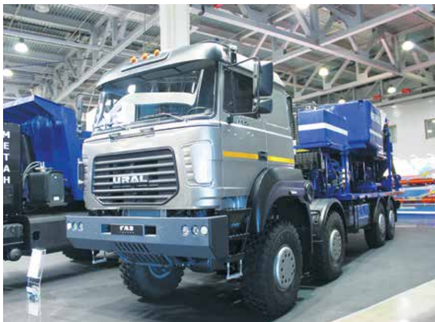
Автомобиль «Урал-9593» (8x8) с цементировочным агрегатом
