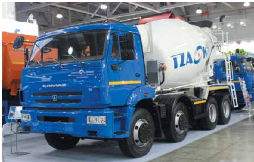
Автобетоносмеситель 58147 У на шасси КамАЗ-6540
