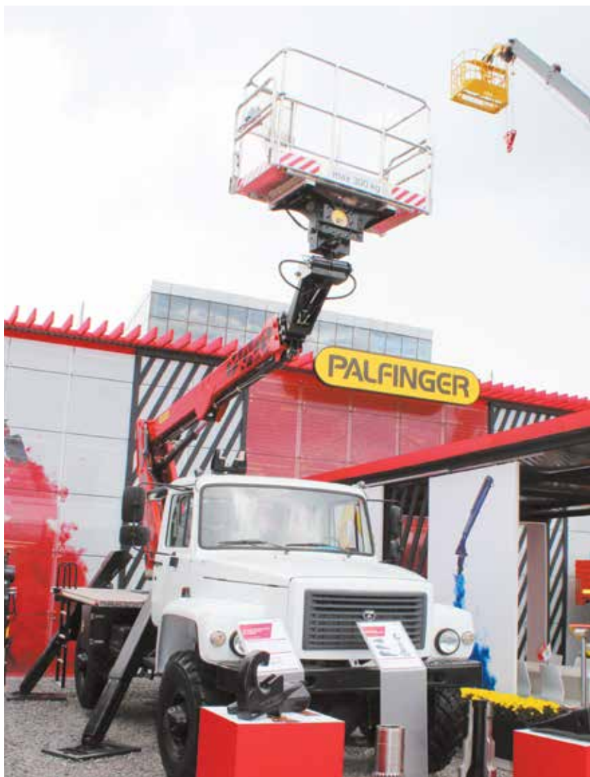
Автогидроподъемник «ВЕЛМАШ-Palfinger P180T» на шасси ГАЗ-33081
