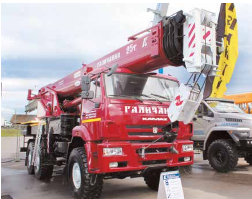
Автомобильный кран КС-55731-4 «Галичанин» грузоподъемностью 25 тонн
