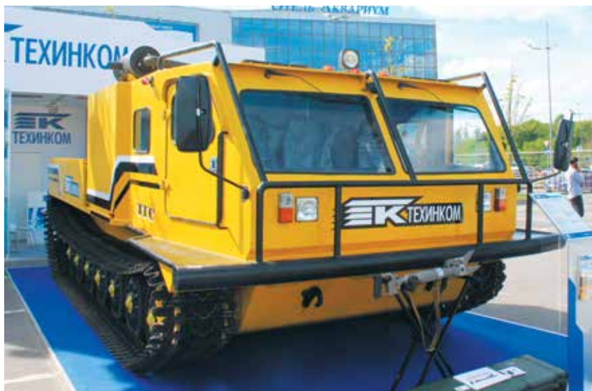
Гусеничный специальный тягач ТТС грузоподъемностью 4,5 тонны
