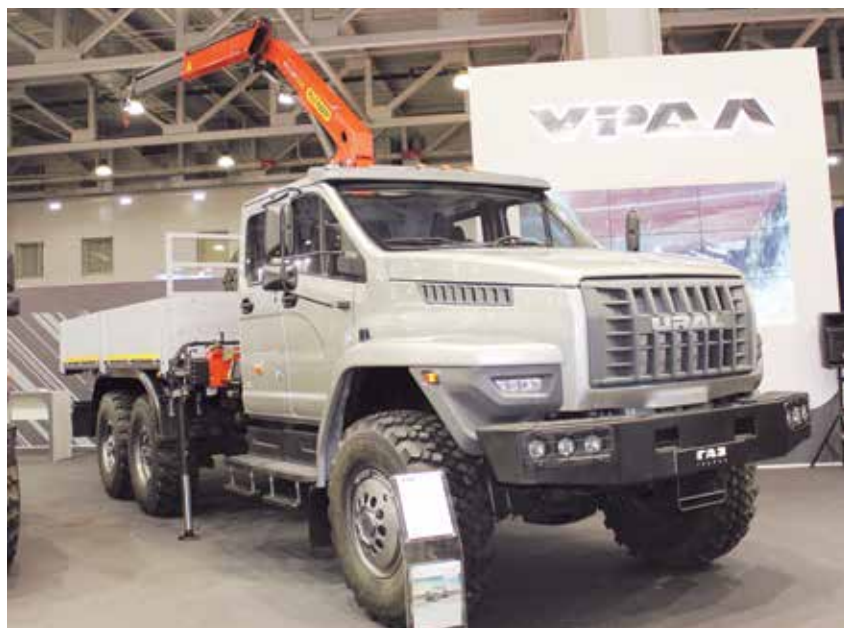
«Урал NEXT» (6x6) с двухрядной кабиной для выполнения ремонтных работ
