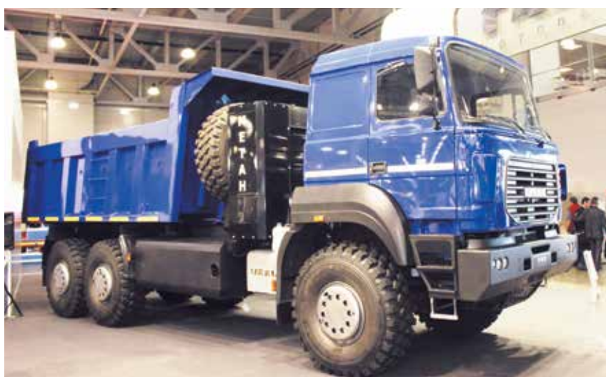
Самосвал «Урал-6370 CNG» с газобаллонным оборудованием
