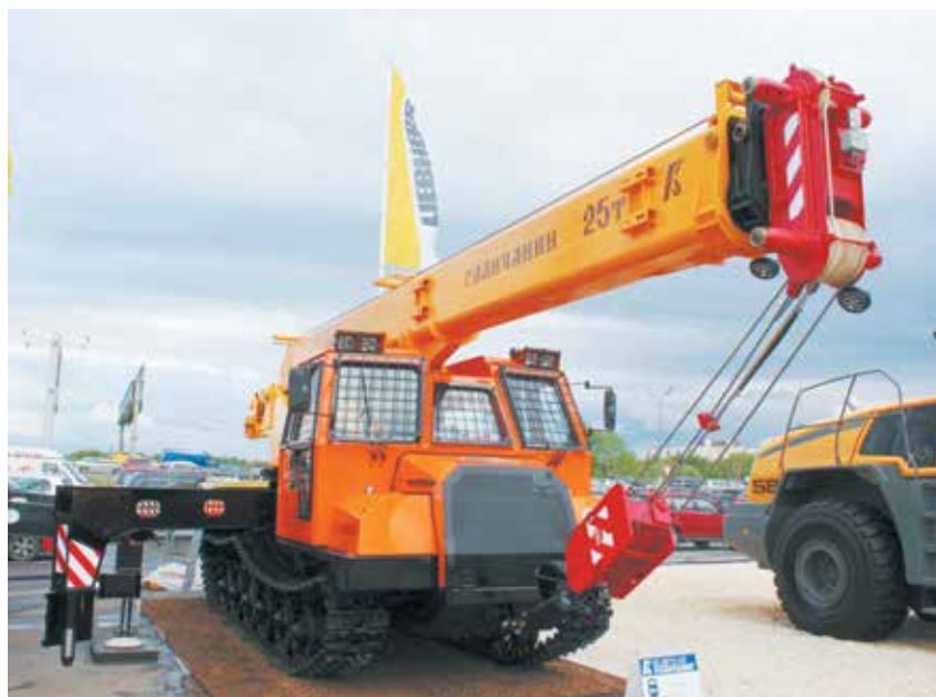
Гусеничный кран КС-59713-14Т «Галичанин» грузоподъемностью 25 тонн
