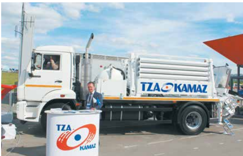
Автобетононасос CityPump на шасси КамАЗ-43253
